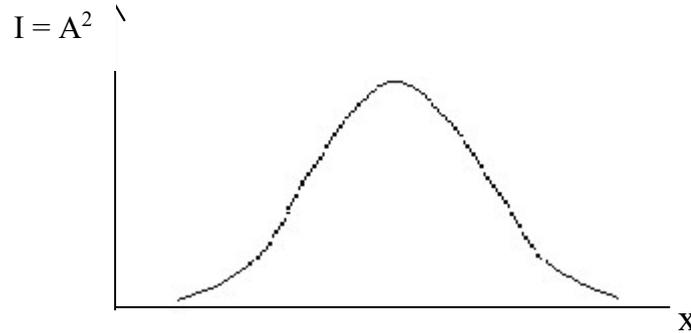
2. В случае нелинейной среды,  $n = n_0 + n_2 I$ , фазовая скорость по сечению пучка неодинакова  $v_{\phi} = \frac{c}{n_0 + n_2 I}$
