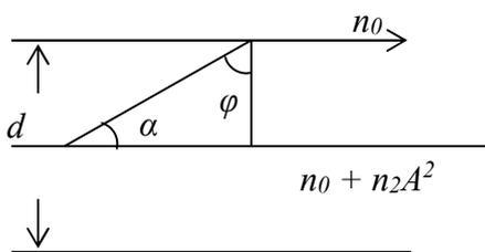
Рассмотрим луч, который вследствие дифракции отклонился и испытал полное внутреннее отражение.
